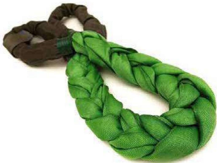
Las eslingas redondas trenzadas proveen gran seguridad en el manejo de cargas muy pesadas y mantienen las cualidades de las eslingas redondas. Las eslingas redondas trenzadas son construidas usando 3 (6 partes) o 4 (8 partes) eslingas redondas RoundUp®. Este tipo de eslingas ofrecen un desempeño superior en los arreglos verticales, enlazados y de canasta.
